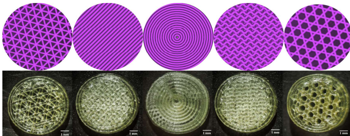
Hình 5. Ảnh viên thiết kế (phía trên) và ảnh viên in thực tế (phía dưới) Cấu trúc bên trong viên: (a) tam giác; (b) đường thẳng; (c) đồng tâm; (d) dạng xoắn; (e) lục giác
